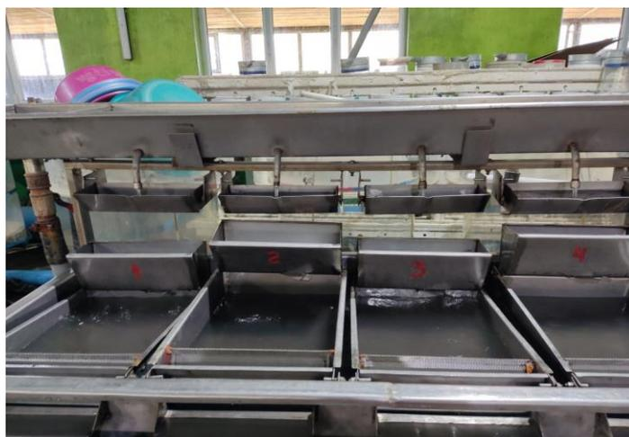
Рисунок 2 - Инкубационный аппарат Осетр
